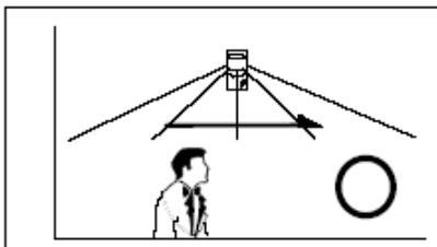
Pour obtenir la meilleure sensibilité, le PIR-3SP devra être monté de façon à détecter l'intrus traversant la zone plutôt que l'intrus s'approchant ou s'éloignant du détecteur.
